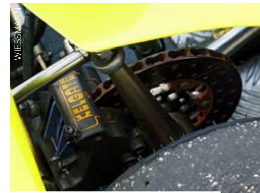
Effektive Stopper: Die Scheibenbremsen
